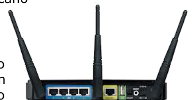
Router con 4 porte ethernet e antenne per il WiFi
